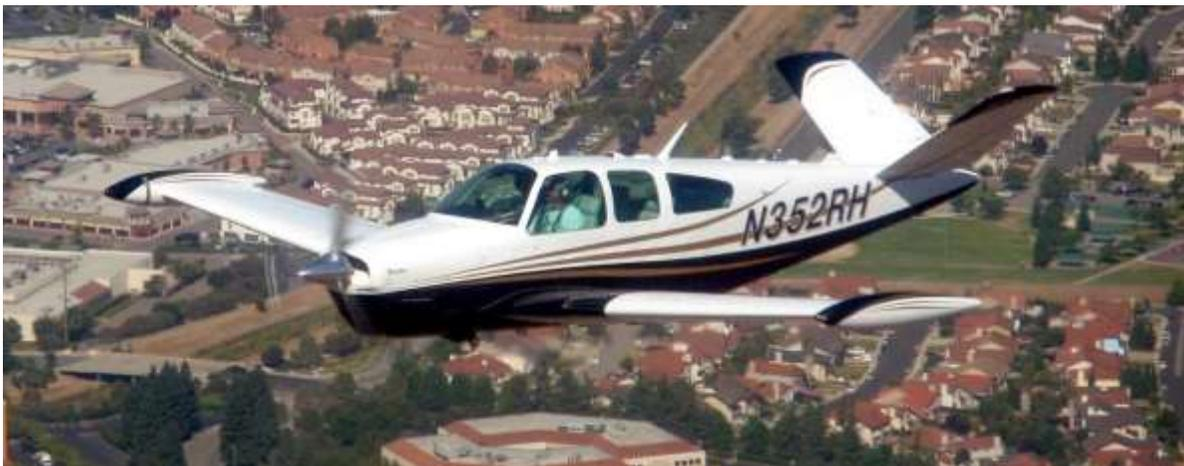
*Ilustración 32: Tip Tanks de un Bonanza S35 (by American Bonanza Society)*
